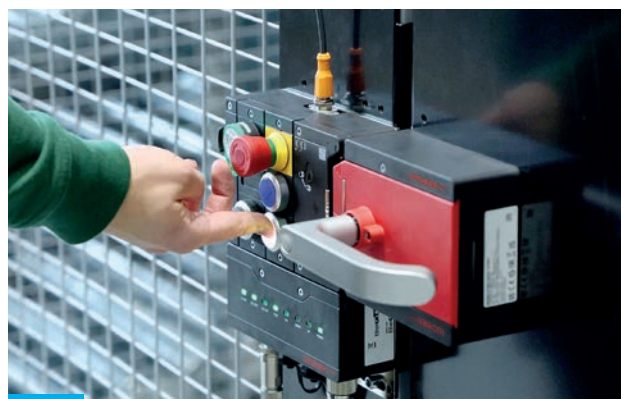
In samenwerking met Euchner ontstond een oplossing op maat op basis van het veiligheidsdeursysteem MGB2 Modular en het sleutelsysteem CKS2.
