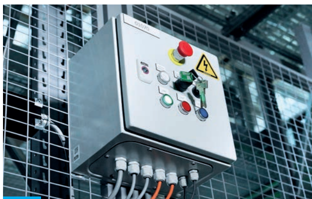
De verouderde zelfontwikkelde beveiligingstechniek uit de beginjaren: een nogal grote aansluitkast met complexe bedrading en mechanische sleutels.
